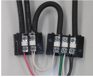
図2. 変圧器代用の端子台説明図
